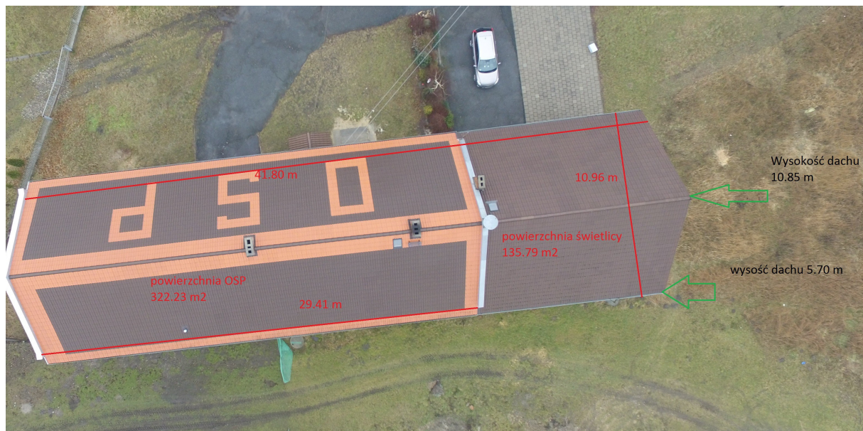
Zdjęcie 2. Stan obecny pokrycia dachowego – wymiary dachu
